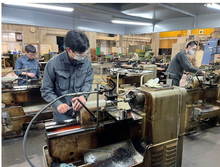
図1 研修の様子（ドリルを用いた穴あけ加工）
