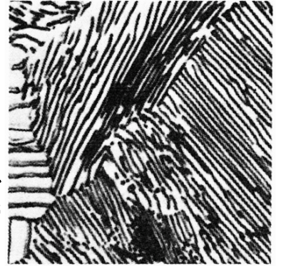
図 13.4 パーライト [金属材料工学 改訂・SI版, 森北出版]
