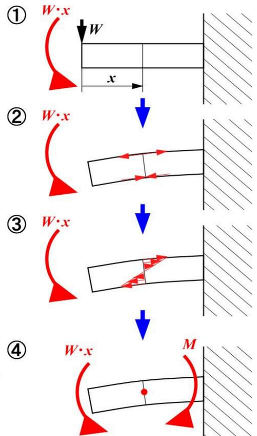
図 13.9 はりの曲げ応力の模式図
