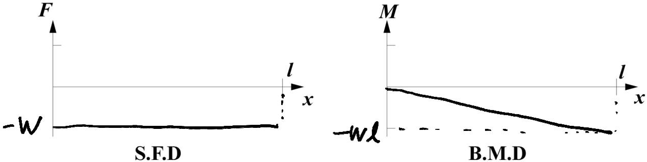
図 13.5 集中荷重を受ける片持ちはり S.F.D.および B.M.D
