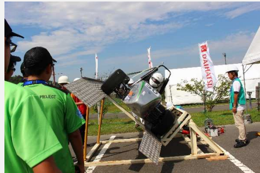
チルト試験（ガソリン漏れ試験）
