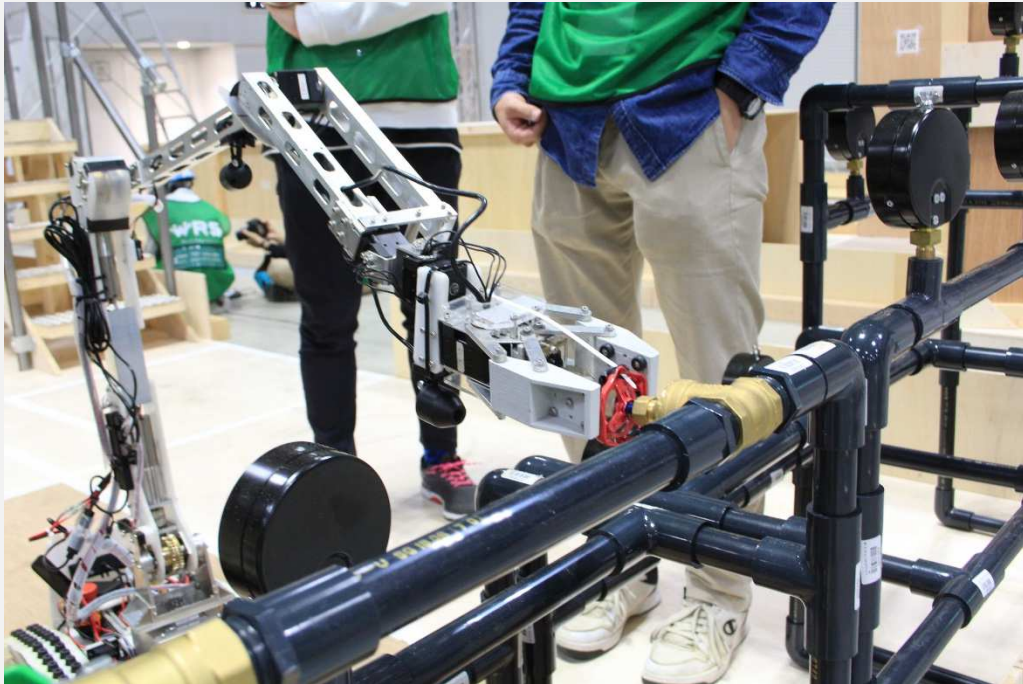
メーター読み取り・バルブ回転試験
