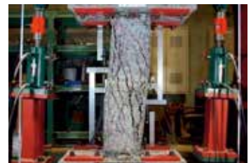
鉄筋コンクリート柱の破壊実験
