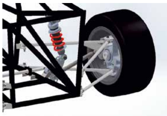
3D CAD で設計したレーシングカーの足回り
