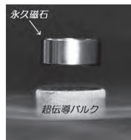
超伝導バルクによる永久磁石の浮上の様子
