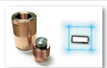
10 GPa級圧力セルと圧力誘起超伝導体
