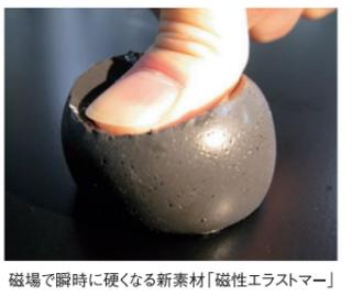
磁場で瞬時に硬くなる新素材「磁性エラストマー」
