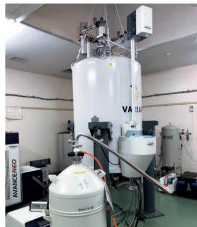
有機化合物の構造決定に用いる高分解能700 MHz NMR装置
