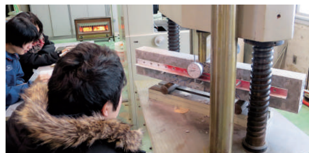
鉄筋コンクリートはりの曲げ加力試験
