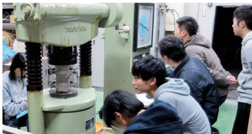
コンクリートの圧縮試験
