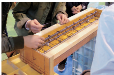
鉄筋コンクリートはりの製作風景
