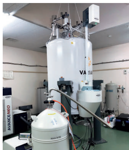
有機化合物の構造決定に用いる高分解能700 MHz NMR装置 High-resolution 700 MHz NMR instrument for structural analysis of organic compounds
