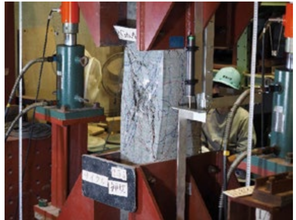
鉄筋コンクリート柱の破壊実験
