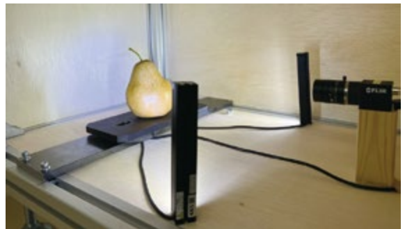
画像による外観品質判定装置 Appearance Quality Judgement System Using Image Processing
