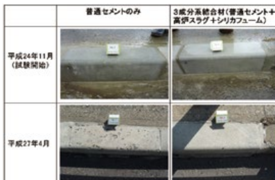
溶融スラグを骨材として用いたコンクリートの耐凍害性
