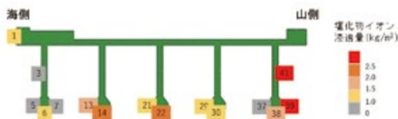
薄板モルタル供試体による橋梁各部位(PC T桁)の飛来塩分環境評価例
