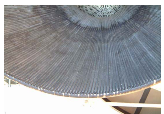
ろう付だけで組み立てられたノズルスカート
