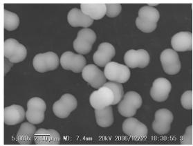
硫酸ストロンチウム(結晶の寸法は、約 0.002 mm)
