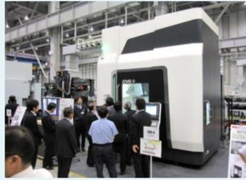
当社は世界のものづくりを支える「立形研削盤」を製造販売しているメーカーです。「研削盤」は、0.001ミリという高い精度で部品を仕上げる機械であり、自動車・建設機械・航空機など幅広い業界で国内外を問わず活躍しています。
