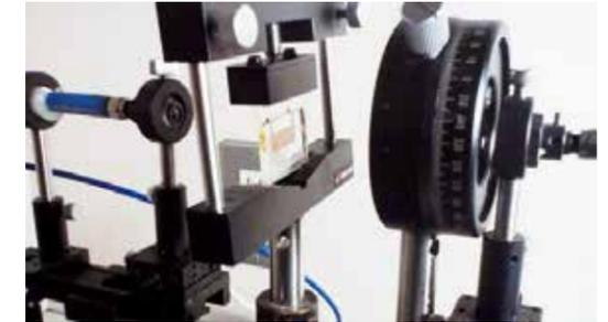
▲透過型表面プラズモン共鳴バイオセンサーの測定系
