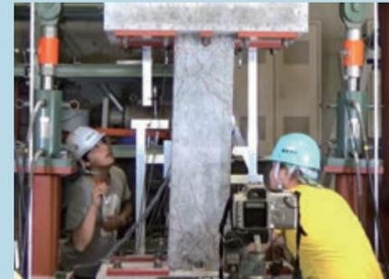
鉄筋コンクリート柱の破壊実験
