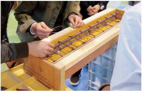
鉄筋コンクリートはりの製作風景
