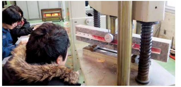
鉄筋コンクリートはりの曲げ加力試験
