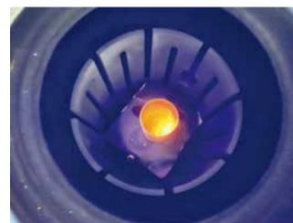
超高温炉による次世代照明用発光材料の合成
