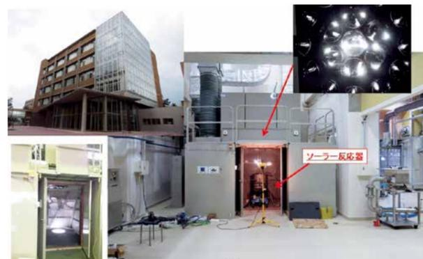
実験用大型太陽光シミュレータによる集光太陽熱の化学エネルギー転換
